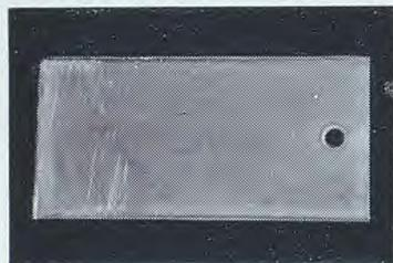
Eprouvette en tôle d'acier recouverte d'un film de vernis au four à base de résines "Epikote" après essai de décompression. On notera l'absence de cloques. La transparence du vernis permet d'apercevoir les rayures effectuées lors du ponçage de la tôle avant application du vernis.
