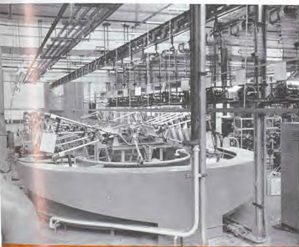
Installation automatique d'oxydation anodique et coloration
